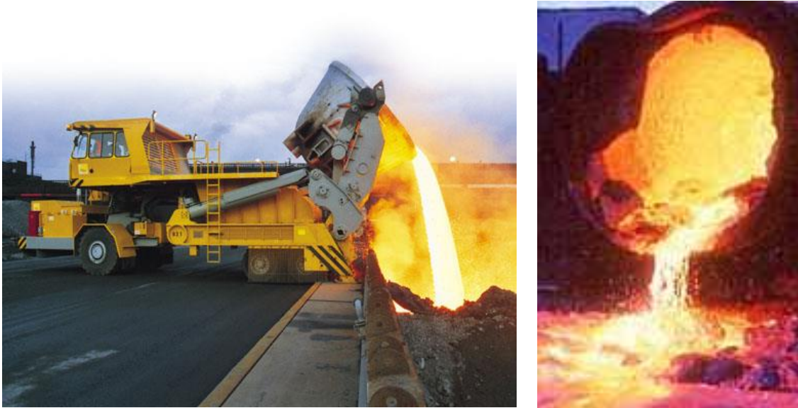
Bild 2: Abguss von Stahlwerksschlacke ins Beet [Lit 14]
